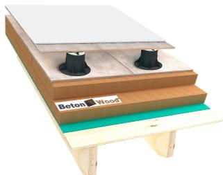
Sistema completo ventilato riflettente con supporti autolivellanti per isolamento termo-acustico in cementolegno e fibra di legno
