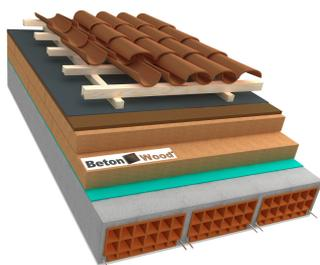
Sistemi ecologici per isolamento termo-acustico di tetti in fibra di legno Therm densità 160 kg/m<sup>3</sup> e fibra di legno bitumata densità 280 kg/m<sup>3</sup> su laterocemento
