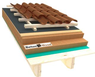
Sistemi ecologici per isolamento termo-acustico di tetti in fibra di legno Therm densità 160 kg/m<sup>3</sup> e fibra di legno Isorel densità 230 kg/m<sup>3</sup> su perlinato
