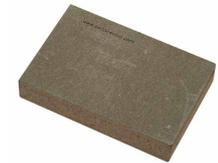
**BetonWood** Il pannello è realizzato in conglomerato cementizio tipo Portland e fibra di legno di Pino scortecciato, ad alta densità ( $\delta=1350 \text{ Kg/m}^3$ ) e con le seguenti caratteristiche termodinamiche: coefficiente di conduttività termica  $\lambda=0,26 \text{ W/mK}$ , calore specifico  $c=1,88 \text{ KJ/Kg K}$ , coefficiente di resistenza alla penetrazione del vapore  $\mu=22,6$  e classe di reazione al fuoco A2-fl-s1, secondo la norma EN 13501-1.
