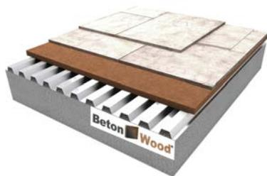
Sistema a secco completo per pavimenti e solai con pannelli ad elevata resistenza meccanica in cementolegno BetonWood e fibra di legno Base su lamiera grecata
