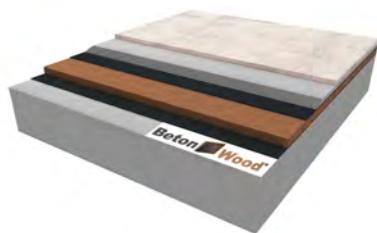
Sistema a secco completo per pavimenti con pannelli in fibra di legno FiberTherm Base, cementolegno BetonWood ed una gettata in calcestruzzo
