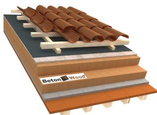
Sistemi ecologici per isolamento termo-acustico di tetti in cementolegno densità 1350 kg/m<sup>3</sup> e fibra di legno Therm densità 160 kg/m<sup>3</sup> su mezzane in cotto
