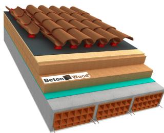
Sistemi ecologici per isolamento termo-acustico di tetti in fibra di legno Therm densità 160 kg/m<sup>3</sup> e fibra di legno Isorel densità 230 kg/m<sup>3</sup> su laterocemento
