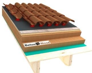
Sistemi ecologici per isolamento termo-acustico di tetti in cementolegno densità 1350 kg/m<sup>3</sup>, fibra di legno Therm e fibra di legno Isorel su perlinato
