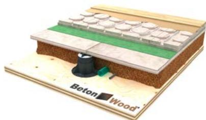
Sistema a secco completo per pavimenti galleggianti con pannelli radianti Betonradiant e cementilegno BetonWood con supporti regolabili su granulato in sughero
