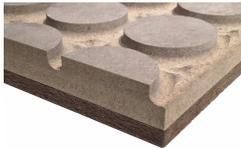
**BetonRadiant Fiber** Beton Radiant Fiber è un sistema modulare per la realizzazione di pavimenti radianti ed è costituito da un pannello in cemento-legno, ad alta densità (1350 Kg/m<sup>3</sup>) come da normativa europea EN 13986, ed uno di fibra di legno FiberTherm.
