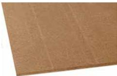
**FiberTherm Base** Il pannello in fibra di legno FiberTherm Base è un isolamento termico rigido e completamente ecologico ideale per la realizzazione di massetti a secco e ad umido, e solai calpestabili grazie alla sua elevata resistenza a compressione ( $150 \text{ kPa}$ ), alla sua densità pari a  $250 \text{ kg/m}^3$ , ed alle sue proprietà di isolamento acustico anticalpestio.
