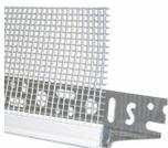
**BetonDripStarter PVC** Profilo di partenza in pvc con rete termosaldata in fibra di vetro  $165 \text{ gr/mq}$  certificata ETAG004. Collegamento a tenuta tra la base di partenza e la rasatura armata. Interrompe lo scorrimento dell'acqua evitando infiltrazioni. Impedisce le fessurazioni nella zona di zoccolatura. Dimensioni  $2,5 \times 0,125 \text{ m}$ . 25 pezzi per confezione.
